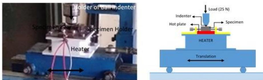
Gambar 1. Diagram mesin uji aus [14]
