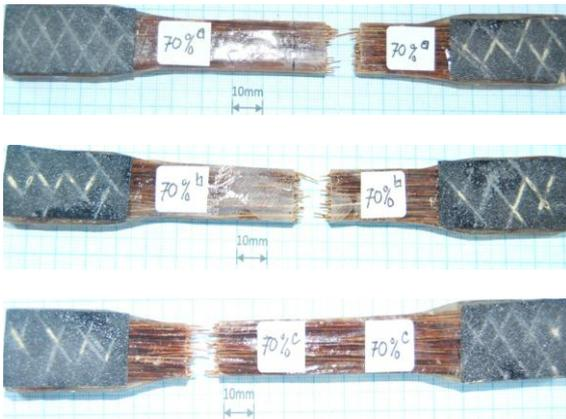
Gambar 11. Permukaan Patahan Komposit Tarik Fraksi Volume Serat 70%
