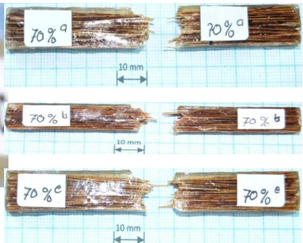
Gambar 17. Permukaan Patahan Komposit Impak Fraksi Volume Serat 70%
