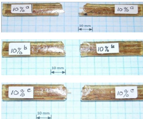
Gambar 15. Permukaan Patahan Komposit Impak Fraksi Volume Serat 10%
