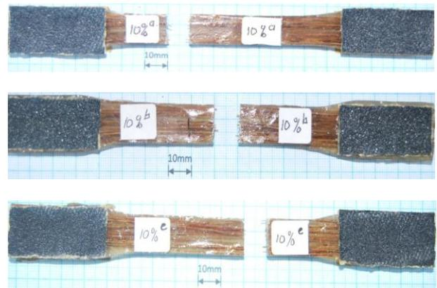
Gambar 9. Permukaan Patahan Komposit Tarik Fraksi Volume Serat 10%
