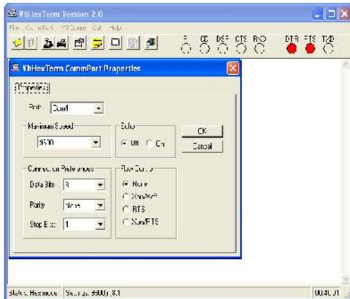
**Gambar 5** - Pengaturan Beberapa Parameter pada Port Serial
