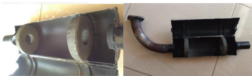
Gambar 7: Catalytic converter dengan katalis karbon aktif dan serbuk nikel
