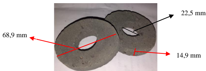
Gambar 6: Campuran katalis yang sudah dipress dan dibentuk
