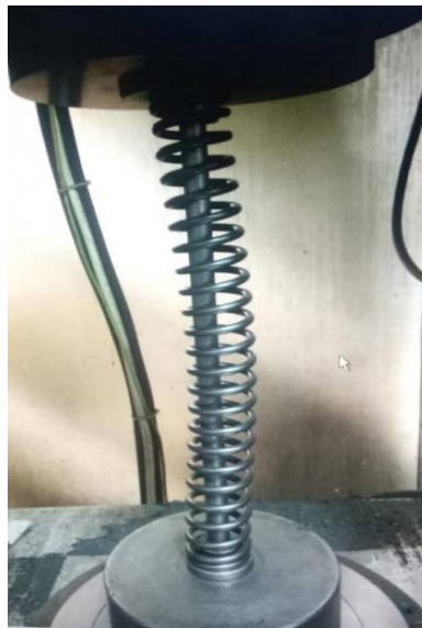
Gambar 5 Foto kerusakan pegas akibat terjadinya buckling over
