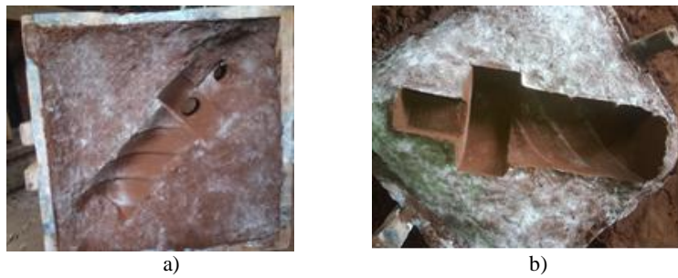
Gambar 1: Pola cetakan pasir basah a) cetakan atas ( cup ), b) cetakan bawah ( dreg )
