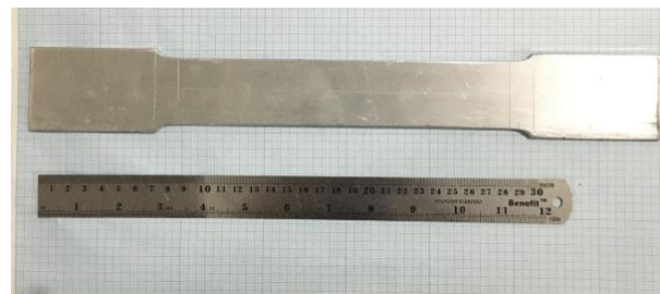
Gambar 2. Spesimen uji tarik ASTM E8
