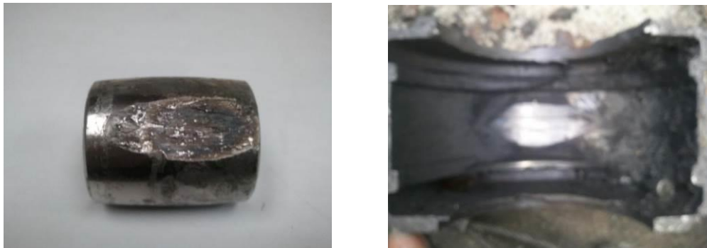
Gambar 3: Bentuk kerusakan roller dan outer race
