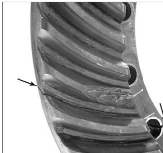
Gambar 11: Kondisi eccentric gear yang mengalami kegagalan
