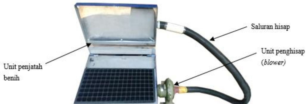
Gambar 13. Konstruksi prototipe mesin penyemai portabel tipe vakum.
