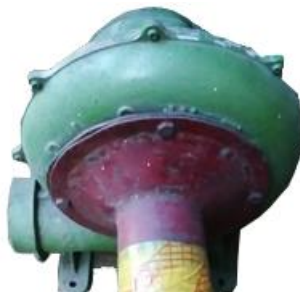
Gambar 11. Jenis blower elektrik yang digunakan (tipe 2.5” lubang inlet, 220 V AC).
