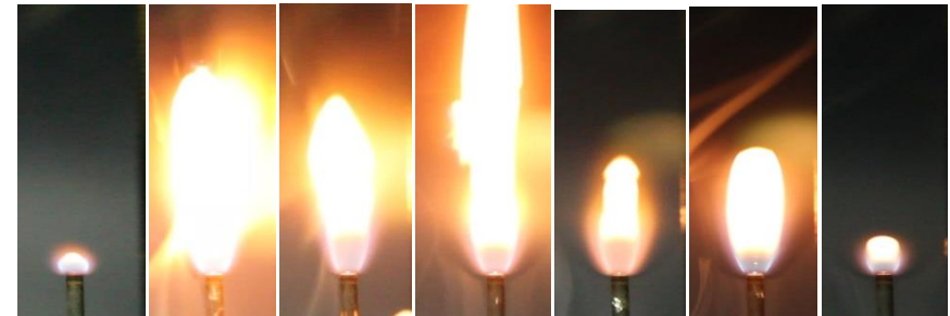
Gambar 14. Nyala api bahan bakar biodiesel-metanol pada mini glass tube dengan debit 4,5 ml/hr
