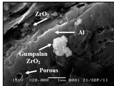
Gambar 4. Foto Mikro Komposit Al-ZrO 2 (pembesaran 20000x)
