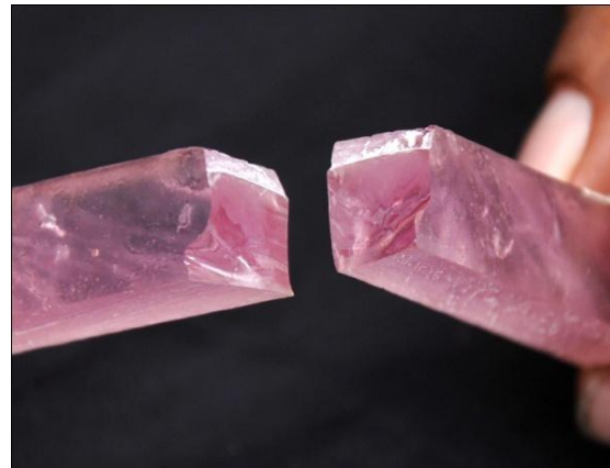
Gambar 10. Pola Patahan Komposit Uji Impact Fraksi Volume 0 % Serat
