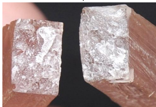
Gambar 7. Pola Patahan Komposit Uji Tarik Fraksi Volume 0 % Serat
