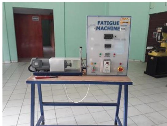
Gambar 1. Mesin uji fatik tipe pembebanan di ujung
