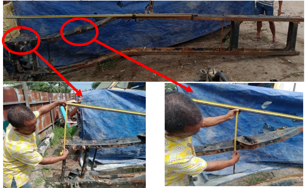
Gambar 10. Pengukuran Displacement Sasis secara langsung
