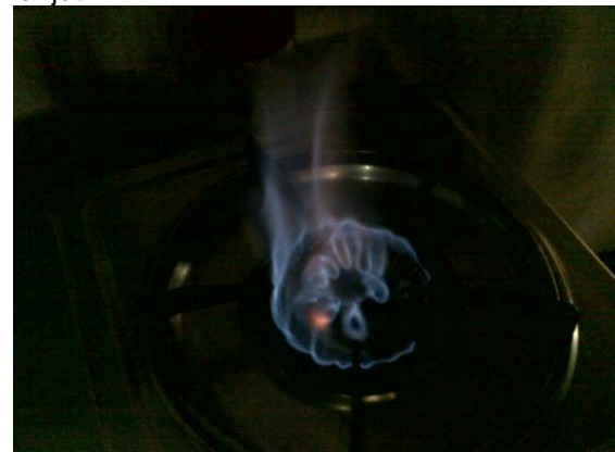
Gambar 6. Warna api biogas yang terbakar pasca purifikasi menggunakan zeolit
