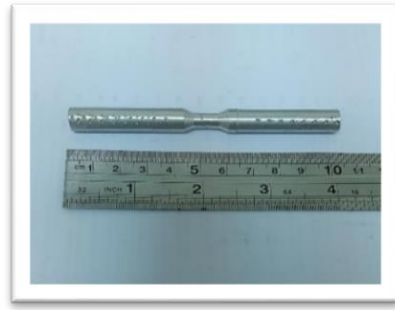
Gambar 2. Spesimen Uji Tarik yang telah dipotong sesuai dengan standar ASTM E466
