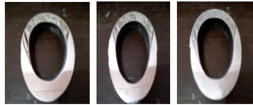
Gambar 12. Spesimen 1, 2, 3 setelah pemanasan 800°C dan sudut bengkok 180 0
