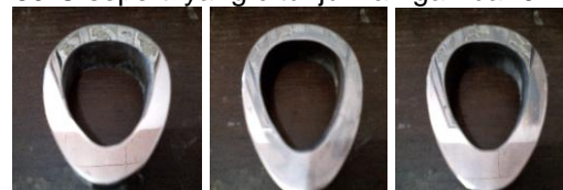
Gambar 8. Spesimen 1, 2, 3 setelah pemanasan 670°C dan sudut bengkok 180°
