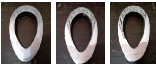
Gambar 6. Spesimen 1, 2, 3 setelah pemanasan 670°C dan sudut bengkok 90°
