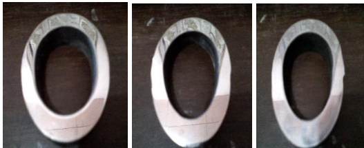
Gambar 10. Spesimen 1, 2, 3 setelah pemanasan 800°C dan sudut bengkok 90 0
