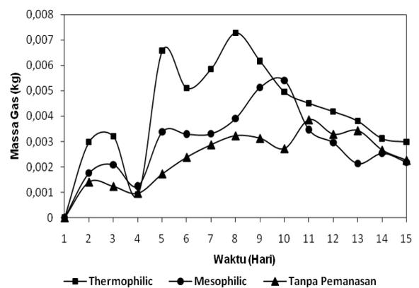
Gambar 3. Grafik hubungan waktu terhadap produksi biogas/hari
