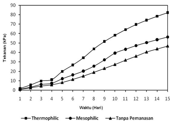
Gambar 2. Grafik hubungan waktu terhadap Perubahan tekanan biogas.
