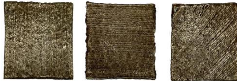
Gambar 4. Hasil Pengelasan Hardfacing metode SMAW
