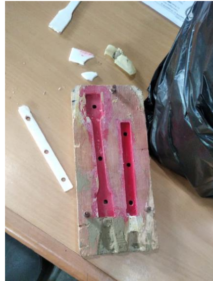
Gambar 5. Lubang pada cetakan untuk memudahkan pengeluaran produk (ejection system)
