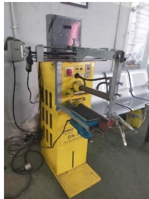
Gambar 2. Foto mesin prototipe preparasi material RSW
