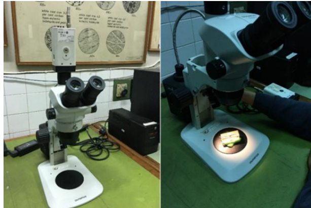
Gambar 3. Proses pengamatan struktur makro, mikroskop optik (kiri) dan proses pengambilan gambar sampel dengan menggunakan mikroskop optik (kanan).
