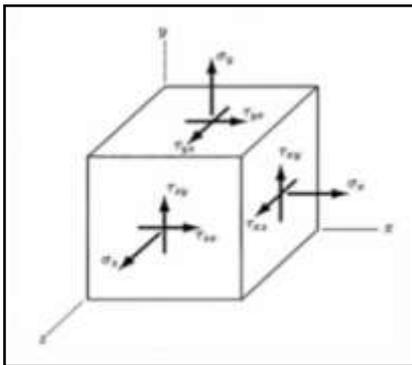
Gambar 3 – Komponen Tegangan
