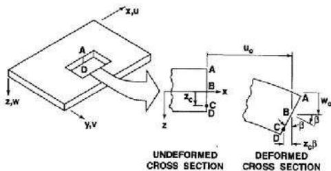
**Gambar 7** – Deformasi Geometri Pada Bidang x-z
