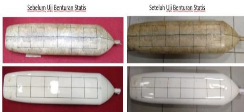
Gambar 12: Kondisi badan wahana sebelum dan setelah mengalami uji benturan statis.
