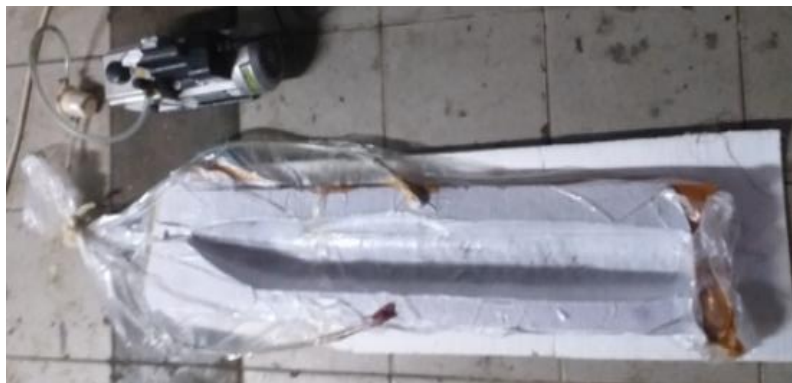
Gambar 5: Proses pencetakan badan wahana tanpa awak.
