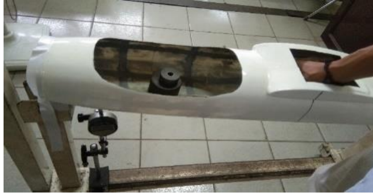
Gambar 6: Proses pengukuran nilai defleksi pada badan wahana tanpa awak.
