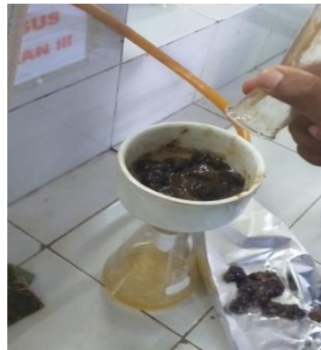
Gambar 4: Proses penyaringan endapan mnr dengan pompa vakum.
