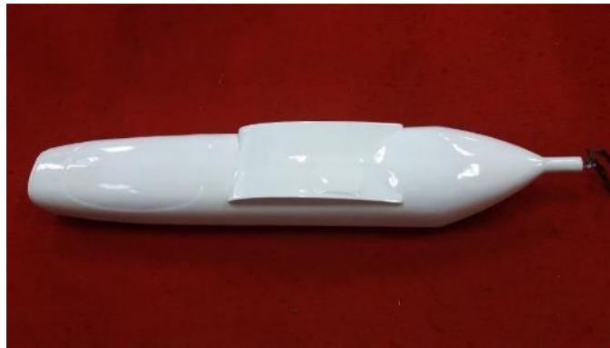
Gambar 9: Hasil pembuatan badan wahana dengan material hybrid fiberglass-fibercarbon .
