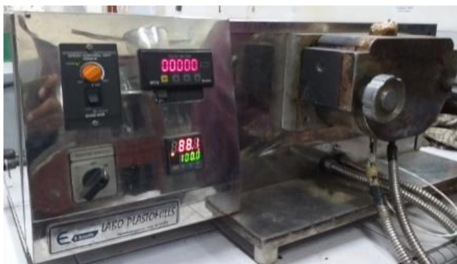
Gambar 3: Proses mastikasi karet alam.
