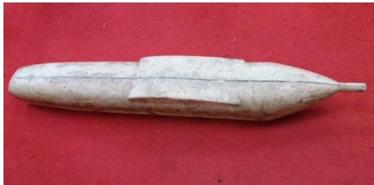
Gambar 8: Hasil pembuatan badan wahana dengan material hybrid fiberglass-serat TKS.
