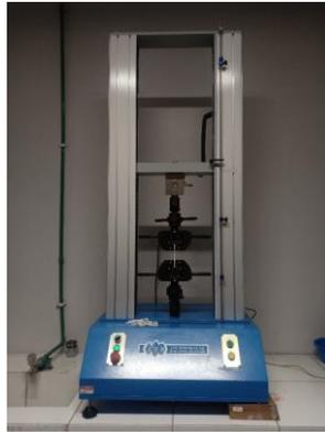
**Gambar 8:** Mesin uji tarik
