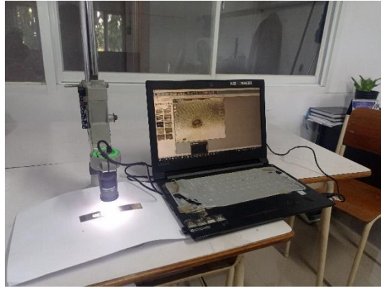
Gambar 4. Pengukuran pada nugget menggunakan mikroskop digital
