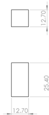
Gambar 1: Bentuk dan ukuran spesimen ASTM D695 dalam milimeter.
