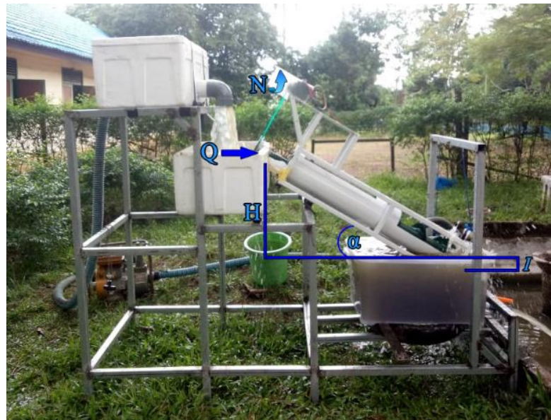
Gambar 4: Posisi pengukuran head ( H ), debit ( Q ), sudut kemiringan turbin ( \alpha ), rpm generator ( N ) dan level rendaman ( I )
