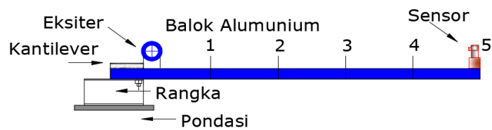
Gambar 3: Skema pengujian getaran
