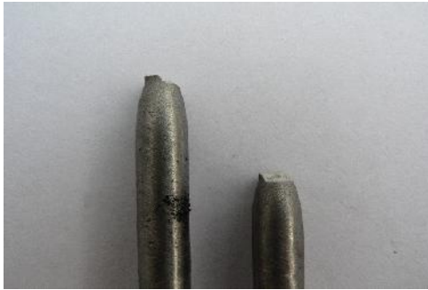
Gambar 12 – Contoh Patahan Benda Uji dengan Posisi Dial 0,2.
