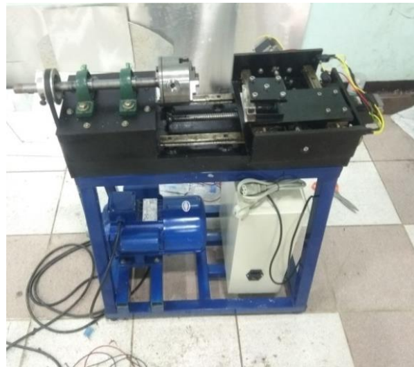
Gambar 2: Mesin CNC Lathe Mini Custom Prodi Teknik Mesin Untan [11] .
