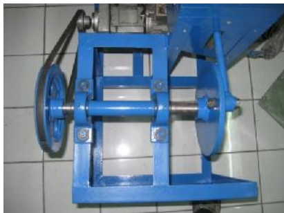
Gambar 4. Sistem Transmisi Alat Perajang
