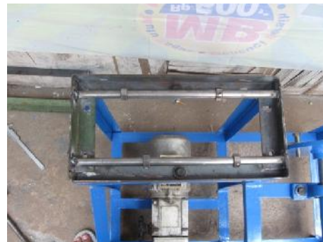
Gambar 5. Lintasan (Rel) Pisau Pemotong
