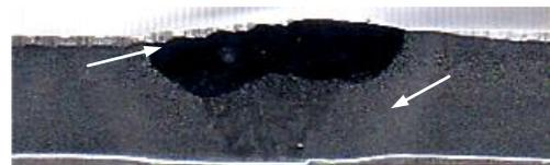
**Gambar 8.** Daerah *Root Pass*, *Cover Pass* dan HAZ
