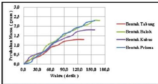
Gambar 4. Hubungan Perubahan Massa dan Bentuk Briket Untuk Briket Dengan Perekat 10 %
