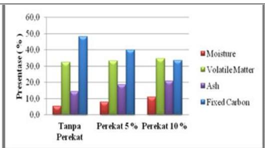
Gambar 11. Prosentase kadar air, kadar abu, zat mudah menguap, karbon tetap dan nilai kalor.
